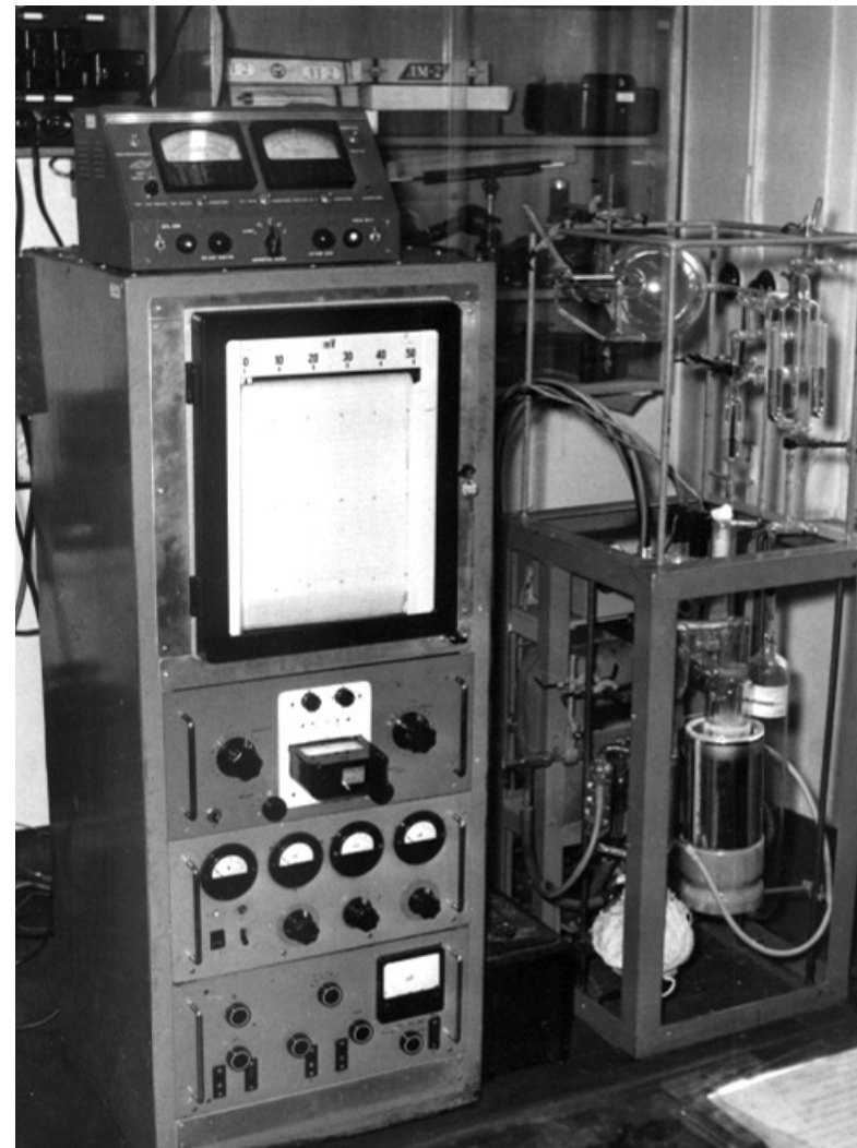
Obrázek1: Celá sestava hmotnostního spektrometru Dempsterova typu v naší laboroři
