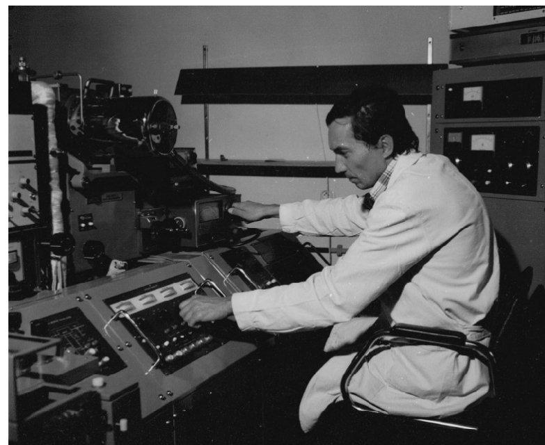
Obrázek 4 Přední ovládací část a vpravo vzadu zdroj hmot. spektrometru Jeol JMS-01-SG2
